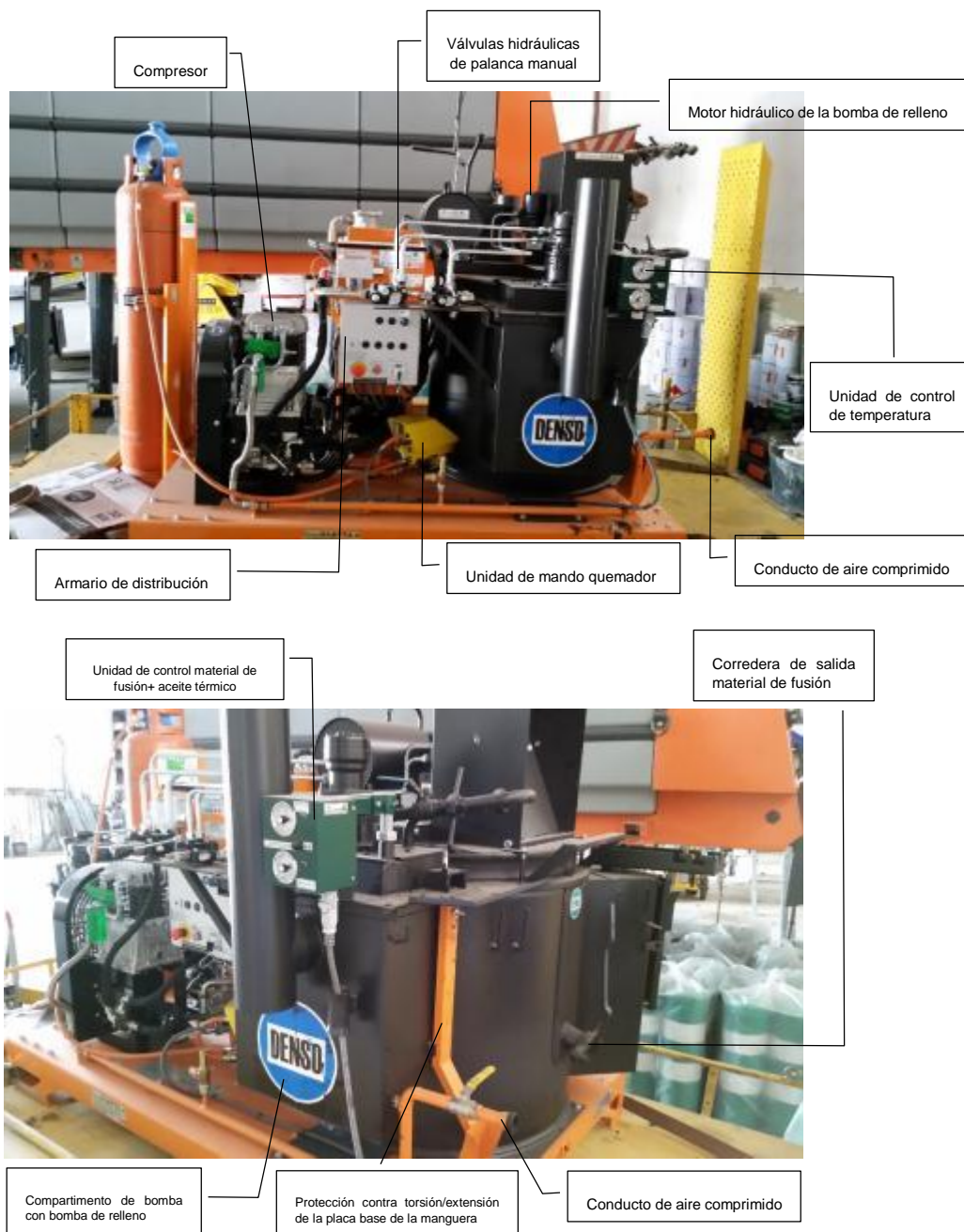
Fotos 1 y 2 .Principales elementos del equipo de relleno "GRÜN RVK 200i".
