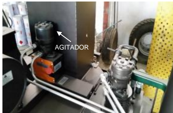
Fotos 8 y 9. Durante el proceso de sellado la temperatura de fusión debe mantenerse agitando la masa continuamente.
